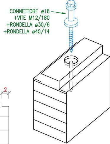
Travi in legno lamellare di abete GL28c certificato PEFC e marcato CE secondo la UNI EN 14080, con scanalature longitudinali per agevolare la posa dell'impalcato in legno e massimizzare la collaborazione a taglio tra travi lignee e soletta in conglomerato calcestruzzo. Scanalature corredate da guarnizioni laterali per mitigare la colatura durante il getto liquido per la formazione di soletta collaborante.
